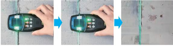
●受光器に合わせてラインが移動しますので微調整が可能です。
